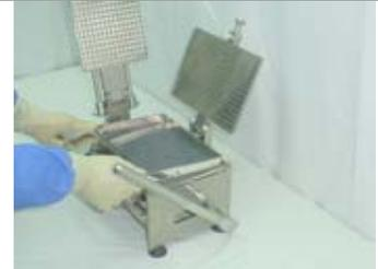
12. Posizionare la cornice sull'opercolatrice. Questo componente serve ad impedire la fuoriuscita delle polveri.
