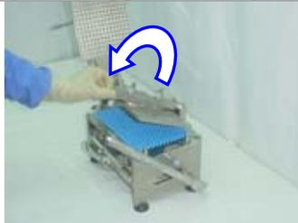
**20.** Abbassare la piastra di bloccaggio e bloccarla utilizzando il gancio di blocco, posto anteriormente.
