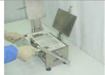
**18.** Sollevare il pressore e spargere la restante polvere nei corpi delle capsule. Rimuovere la cornice polveri.
