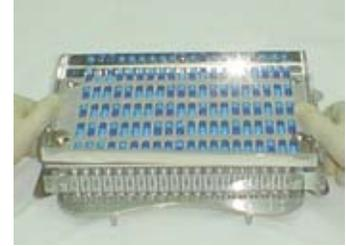
3. Posizionare l'orientatore sul piano teste nella posizione contrassegnata con "I". I perni di guida sul piano teste semplificano questa operazione.
