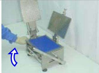
11. Rilasciare la leva a camme. In questo modo, i corpi delle capsule cadranno in modo che le estremità aperte vengano a trovarsi a filo della superficie superiore dell'opercolatrice.
