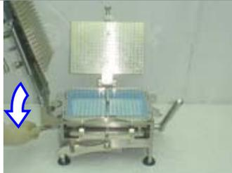
8. Abbassare la leva a camme verso l'operatore per bloccare i corpi delle capsule nell'opercolatrice.
