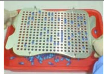
**24.** Capovolgere il piano teste e vuotarlo in un vassoio in plastica. Ora si è pronti per il confezionamento.
