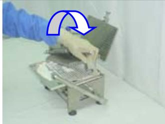
**14.** Abbassare il pressore autobloccante. La compressione consente di inserire più polvere in ciascuna capsula e di ottenere un peso più uniforme
