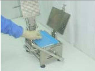
**19.** Posizionare la piastra superiore con le teste sulla opercolatrice, aiutandosi con la piastra di pressione. Rimuovere la piastra di pressione facendola scorrere.
